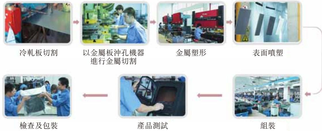
製造電壁爐所用的主要原材料主要包括大理石框架、框架或壁爐架所需的木材及冷軋板。我們電壁爐的主要生產流程包括以下步驟：按特定電壁爐型號的尺寸及規格切割冷軋板。其後，以金屬板沖孔及塑形機器進一步切割金屬板及將其塑造為所需形狀，並於表面噴上粉末塗層。於組裝過程中，我們將各零部件(包括電子組件)組合。有框電壁爐分別嵌入無機、木製或天然石框架。我們在包裝作交付前對成品進行抽樣檢查。平均生產所需時間(即完成上述生產流程所需的時間)約為七天。一般而言，由確認銷售訂單至交付產品的時間約為兩至三個月。
