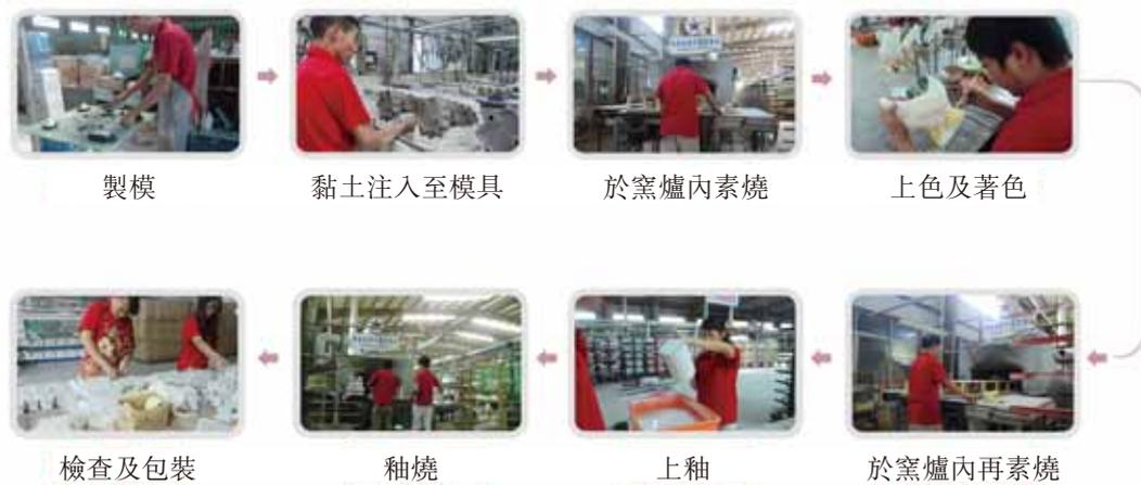
製造陶瓷系列家居裝飾產品所用的主要原材料主要包括重質白雲土或黏土。產品模具製作完成後，黏土將注入模具內，並進行產品鑄造。產品會於窯爐內燒製，其後以人手上色。產品上色後將置於窯爐內再素燒，其後會噴釉，並置於窯爐內再素燒。我們在包裝作交付前對成品進行抽樣檢查。平均生產所需時間(即完成上述生產流程所需的時間)約為七天。一般而言，由確認銷售訂單至交付產品的時間約為兩至三個月。
