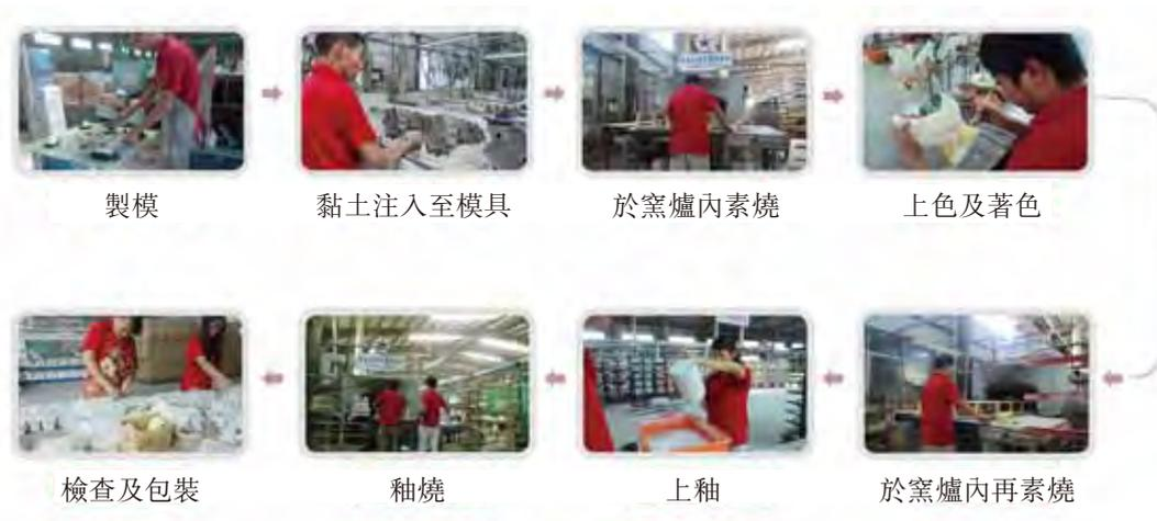
製造陶瓷系列家居裝飾產品所用的主要原材料主要包括重質白雲土或黏土。產品模具製作完成後，黏土將注入模具內，並進行產品鑄造。產品會於窯爐內燒製，其後以人手上色。產品上色後將置於窯爐內再素燒，其後會噴釉，並置於窯爐內再素燒。我們在包裝作交付前對成品進行抽樣檢查。平均生產所需時間(即完成上述生產流程所需的時間)約為七天。一般而言，由確認銷售訂單至交付產品的時間約為兩至三個月。
