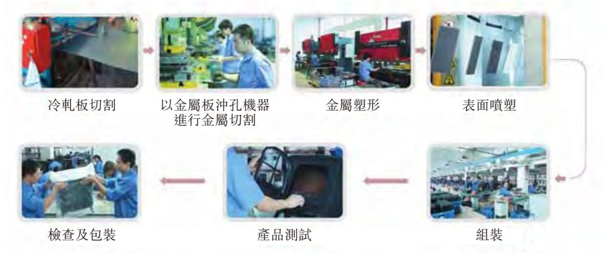
製造電壁爐所用的主要原材料主要包括大理石框架、框架或壁爐架所需的木材及冷軋板。我們電壁爐的主要生產流程包括以下步驟：按特定電壁爐型號的尺寸及規格切割冷軋板。其後，以金屬板沖孔及塑形機器進一步切割金屬板及將其塑造為所需形狀，並於表面噴上粉末塗層。於組裝過程中，我們將各零部件(包括電子組件)組合。有框電壁爐分別嵌入無機、木製或天然石框架。我們在包裝作交付前對成品進行抽樣檢查。平均生產所需時間(即完成上述生產流程所需的時間)約為七天。一般而言，由確認銷售訂單至交付產品的時間約為兩至三個月。
