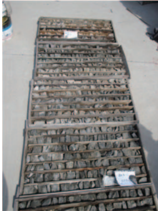
圖 12-2. 鑽孔 ZK-3-11，顯示樣品間隔和手動分開的 NQ 岩芯
