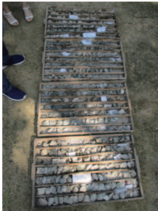
圖 12-3. 鑽孔 ZK-3-2，顯示樣品間隔和手動分開的 NQ 岩芯
