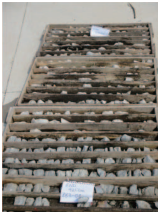
圖 12-1. 鑽孔 ZK-3-8，顯示樣品間隔和手動分開的 NQ 岩芯
