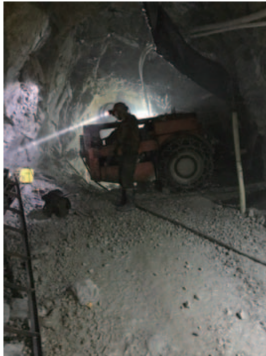
圖 16-2. 山後金礦拉底層電動鏟運機
