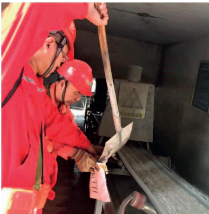
圖 12-6. 英格莊磨機給料採樣
