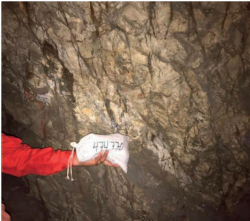
圖 12-2. 英格莊 235 中段細屑刻槽現場 SN474770
