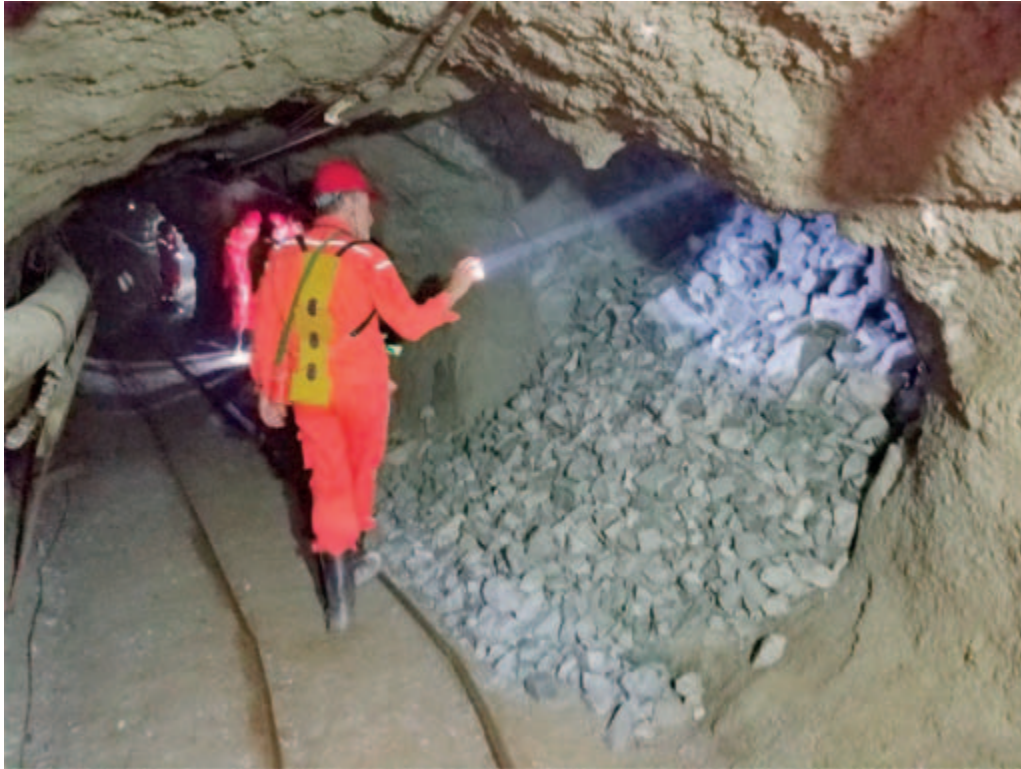
圖 16-2. 礦石盤區底部運輸水平的典型放礦點
