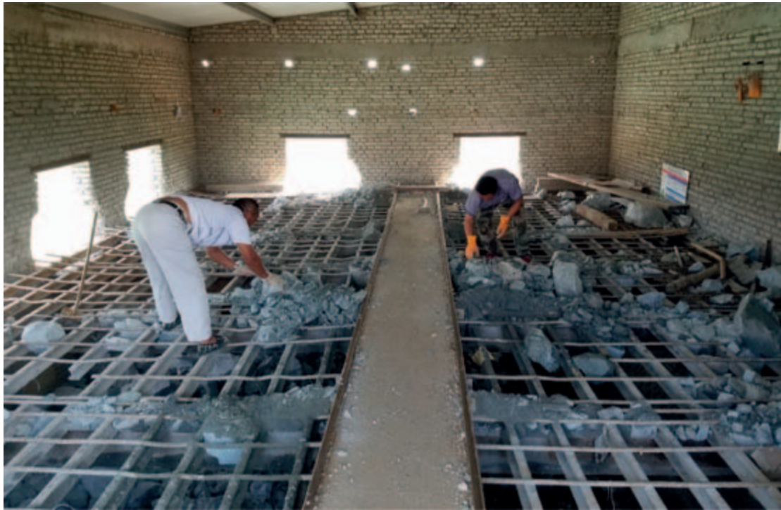
圖 12-3. 核查樣品 474611，東豎井礦石倉格篩， 侯格莊礦脈，6.92 克／噸黃金
