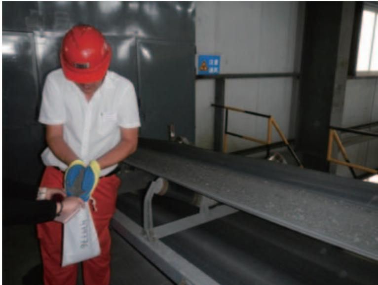
圖 12-5. 赤峰柴胡欄子礦球磨機的破碎礦石進料採樣
