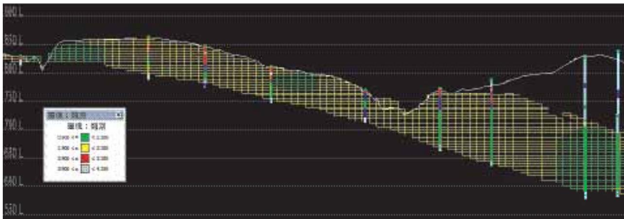
圖 68：區塊模型資源分類 (1= 探明，2= 控制，3= 推斷，4= 無分類)。橫截面 N 8.201.000 (垂直跨大率 = 2 倍)
