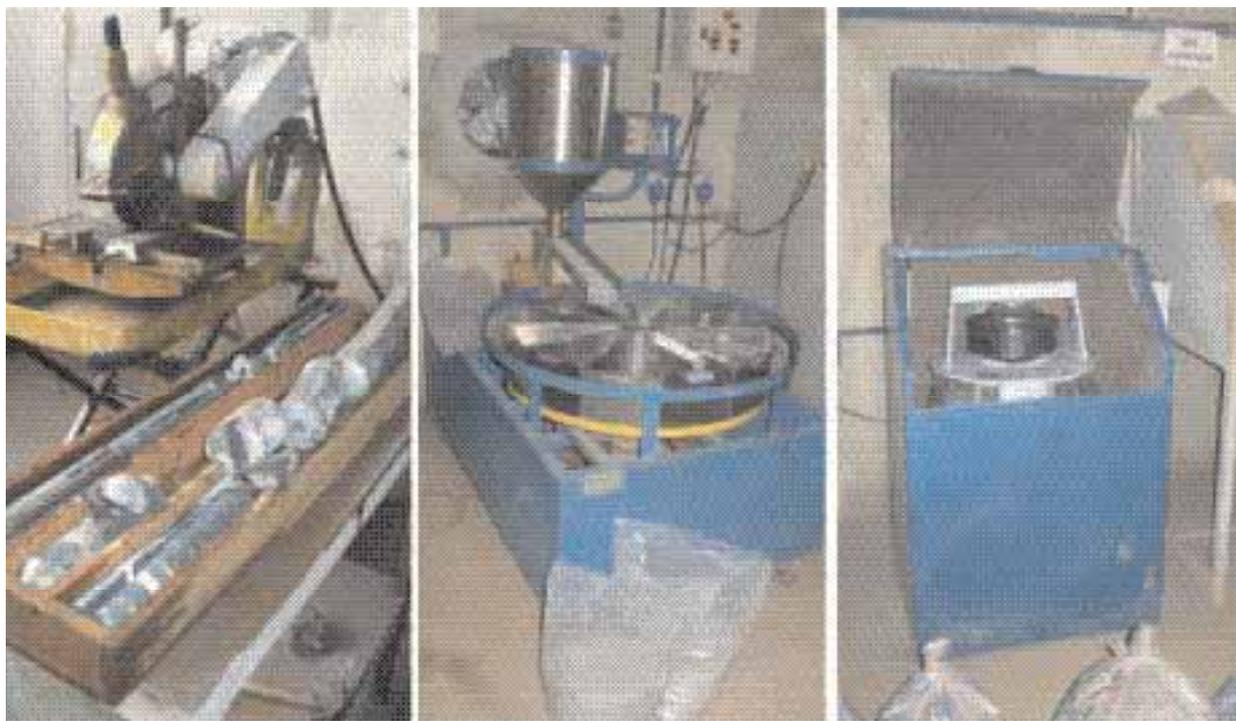
圖 10：製樣所用之設備。岩芯鋸(左圖)、旋轉分離器(中圖)及粉碎機(右圖)
