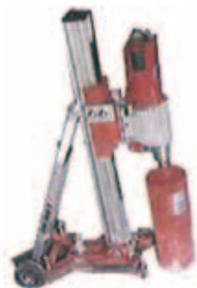
鑽孔機，用於混凝土拆卸工程中的鑽芯工作
