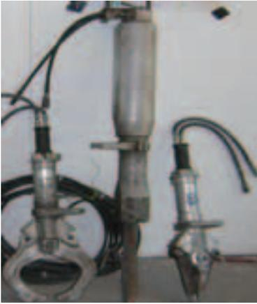
手提碎裂及爆破機，用於混凝土拆卸工程中的爆破工作
