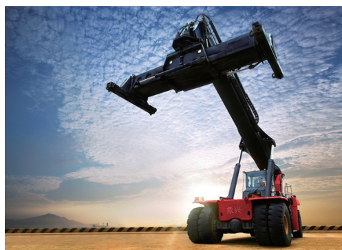
集裝箱正面吊
