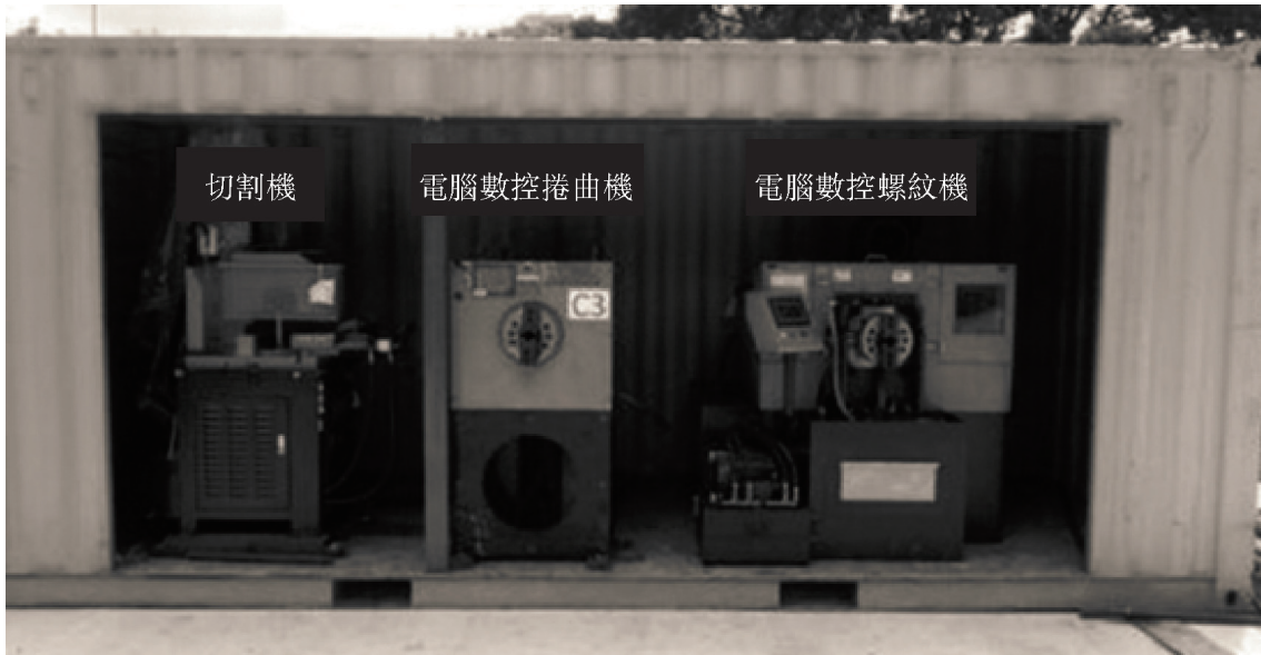
位於車間的三種機械鋼筋並接機
