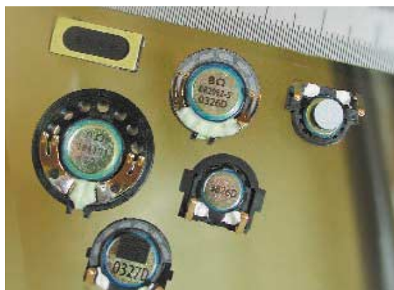
EMS產品—通訊器材使用之小型揚聲器 EMS Product – Miniature Speaker for Telecommunication
