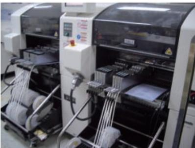
零部件傳達至卷軸上的紙或塑料膠帶或傳送至抗靜電塑膠試管或托盤內，自動鑲入自動組裝機，組裝機電腦程式已預先設定，零部件便組裝至印刷線路板之指定位置。視乎組裝至印刷線路板上之零件的特性，本集團彈性地結合運用三類型自動組裝機（即高速組裝機、中速組裝機及多功能組裝機），以便在產品的質素和生產效率之間取得平衡。經過自動組裝後，由人工檢查確保零件妥善組裝。
