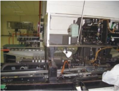
由於物理特性之原因，某些零件無法運用SMT貼裝至印刷線路板。因此，零件會插入印刷線路板上鑽出之通孔，零件之引腳會以自動插件機彎曲。在自動插入元件後進行人工檢驗。無法運用自動插件機貼裝之零件將由人手插入印刷線路板之通孔。其後，將進行人工檢驗，確保零部件妥善組裝。
