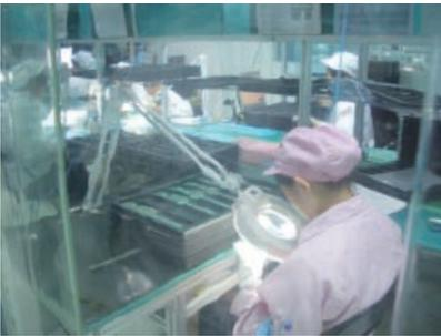
經過最終測試後，印刷線路板經輸送帶運送至密封區域，使被空氣微粒污染之可能性減至最低。最終產品放置於防震及防靜電容器內，隨後密封包裝準備付運。
