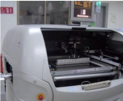
錫膏融接劑（一種改良焊接之化學清潔劑）及微小焊料之混合物）由自動印刷機塗至印刷線路板，此後，印刷線路板將經由輸送帶送至貼裝機。錫膏之厚度經嚴格控制，確保最佳狀態之錫膏用於進一步SMD組裝。本集團採用自動測試設備，確保錫膏之厚度符合預定標準。
