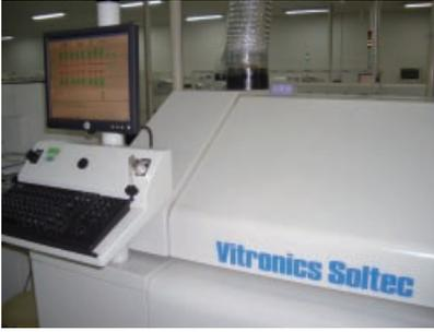
於自動組裝後，印刷線路板經一條輸送帶運送至回流爐，而回流爐獨立間隔設定為參考零件之物理性質設計之溫度梯度。線路板上之錫膏經過熔解，錫膏表面張力有利於保持零件不移位。然後錫膏被冷卻，形成零件與印刷線路板間之焊接點。視乎產品規格及客戶要求，回流爐可利用氮氣進行回流焊接。
