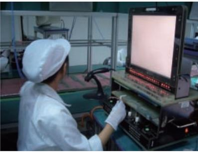
根據產品類型及客戶要求，印刷線路板亦接受功能測試，以確保印刷線路板之電路在特定產品設定下運作良好。此外，將進行樣本測試，以提升整體產品可靠度。
