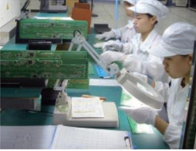
經SMT及DIP加工後，印刷線路板與電路連接，以測試其基本傳導性能。
