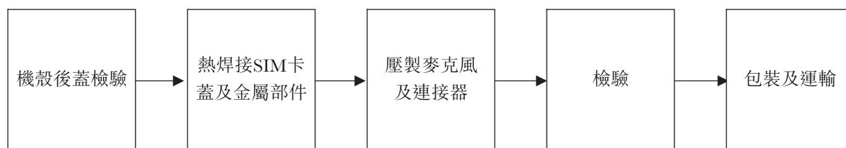
機殼後蓋模組的組裝工序始於來料質量檢查，我們的員工會檢查有無明顯缺陷。接下來，提供接地保護及電磁干擾防護的SIM卡蓋及金屬部件會被添加並以熱焊接方式固定在機殼後蓋的適當位置。熱焊接階段完成後，麥克風及連接器會被壓製在機殼後蓋上。最後，組裝完成的機殼後蓋會被包裝並送交客戶或其組裝服務供應商。
