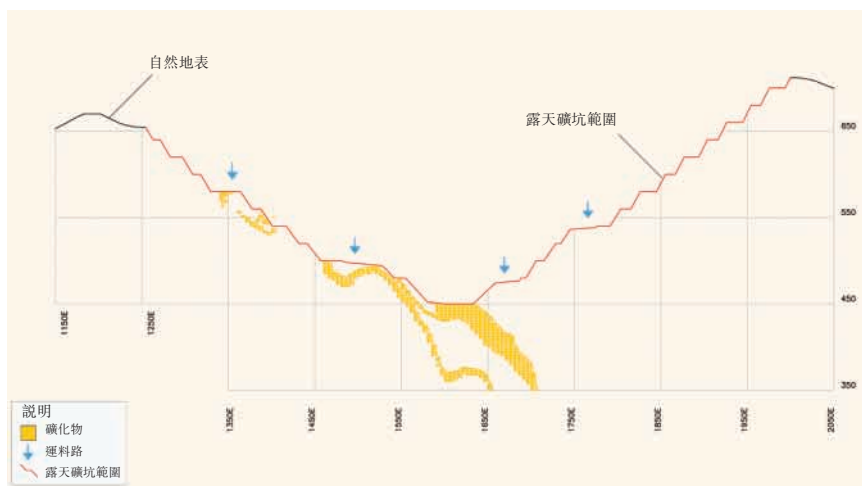
圖5-3：貫穿露天礦坑的概要特徵切面圖 (Matrix Consulting，二零零四年)
