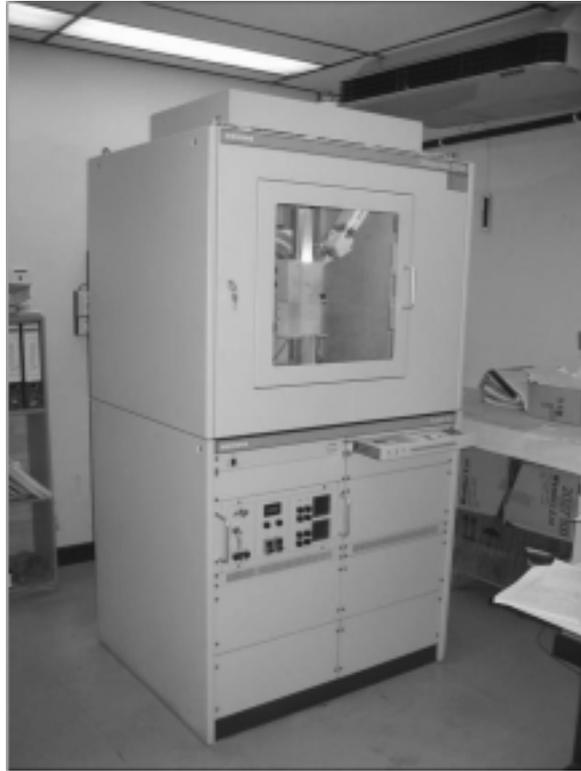
圖42：供XRD分析的西門子D-5000衍射儀。
