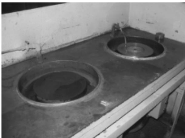
圖32：有旋轉輪的研磨機，用於研磨岩石板。
