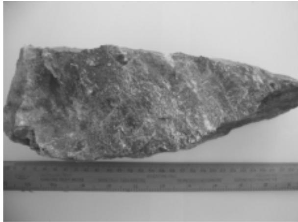
圖29：第一類白雲石(深灰色、細粒至中粒狀大小)。樣本中有礦物線理。
