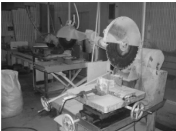
圖31：金剛石鋸片岩石夾頭機器。
