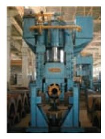
成型過程包括「U」型成型及「O」型成型。就「U」型成型過程而言,將鋼板插入「U」型模內,而鋼板中央部份將向上壓並轉變為「U」型。於「U」型成型後,「U」型鋼板將會移至「O」型模作最後成型。在此過程中,「U」型鋼板將由於兩個半圓型模發出的強大向上及向下壓力而最終轉變成「O」型。
