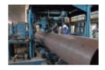
鋼板成型後,成為保留開口的鋼筒並將由鋼筒焊接為管道。此項工序為預焊接。預焊接後的鋼管將進行進一步內部及外部焊接過程以符合行業要求。
