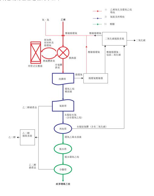
環氧乙烷乃當乙烯及氧各自處於氣態與催化劑作出反應時,由乙烯進行氧化反應 產生。環氧乙烷的生產過程主要分為以下三個階段:
