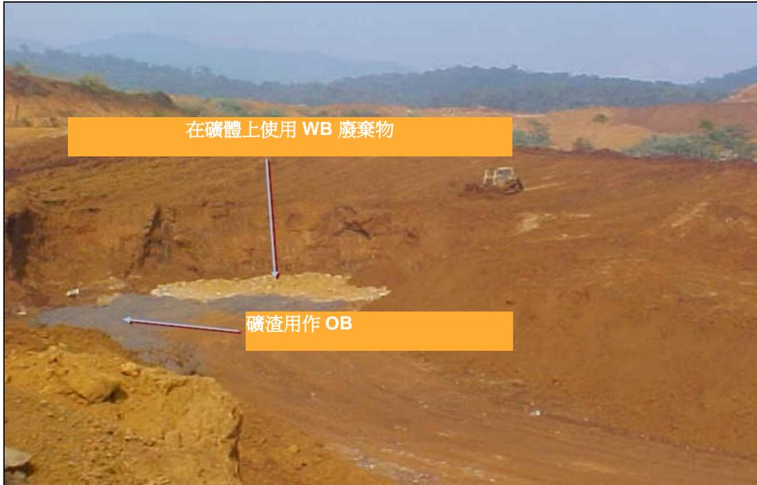
圖 4-20：使用廢舊物料和礦底板礦渣（圖片 PTI）
