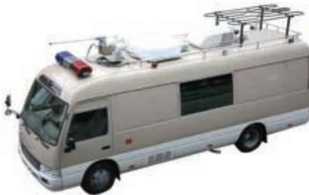
中型地面移動高速動態衛星系統通信車
