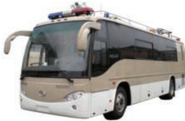
大型地面移動高速動態衛星系統通信車
