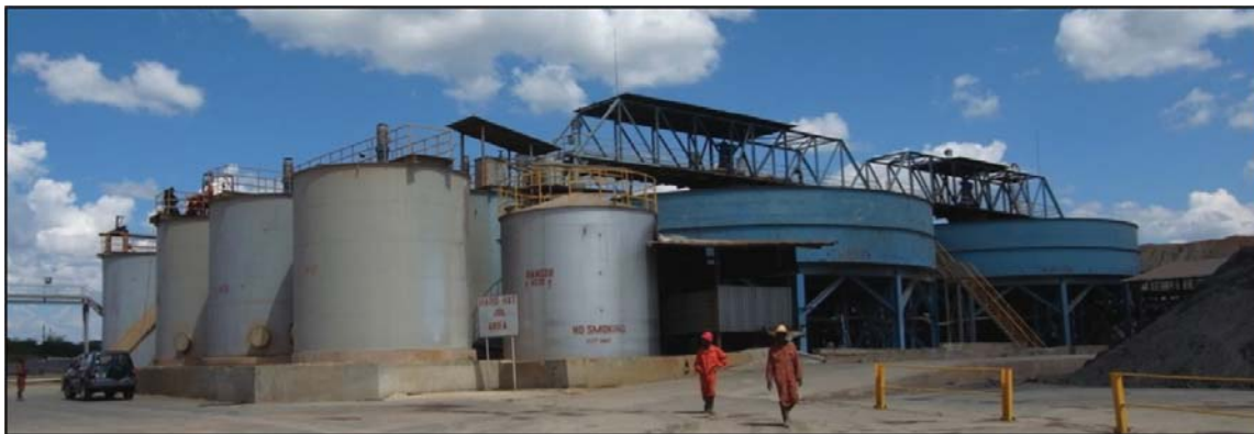
圖8-7：攪拌浸出廠概覽
