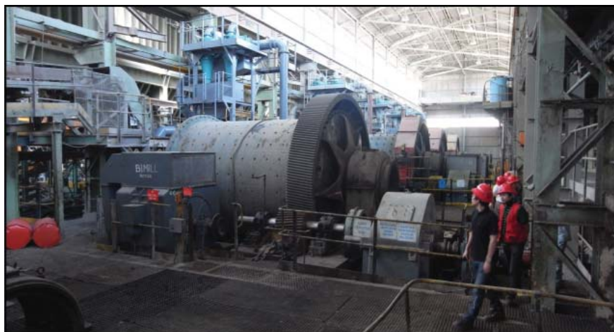
圖8-13：Baluba 選礦廠的球磨機
