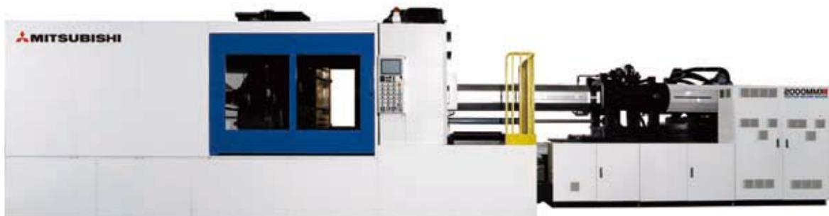
三菱MMX大型兩板注塑機 Mitsubishi MMX Large Tonnage Two Platen Injection Moulding Machine
