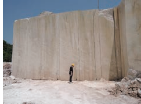
用水平及垂直金剛石帶鋸切割採石面。
