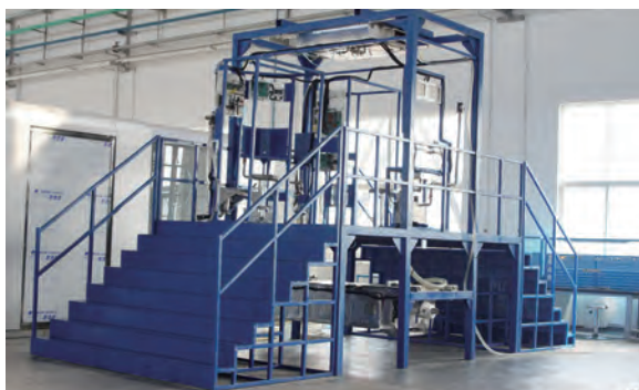
CRH380给水卫生系统模拟试验
