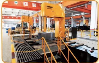
為提升用於特大模架的原材料使用率,鋼材鍛件通常會被鋸切成粗形之後才加工。圖中的立式帶鋸可鋸切高達2.3米厚的鋼塊。
