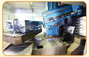
近年,越來越多的塑膠原料需要模具具有更佳的冷卻速度,模具設計者 於是乎把模具內冷卻水路的設計更趨複雜。中國河源及杭州廠均安裝了 五軸深孔鑽,能更有效地提升模具水路設計的靈活性。
