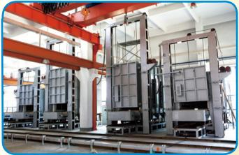
模具行業對材料的硬度均一性要求近年不斷提升,中國杭州廠增設了材料調質及消除應力電爐,為客戶提供更全面的熱處理服務。
