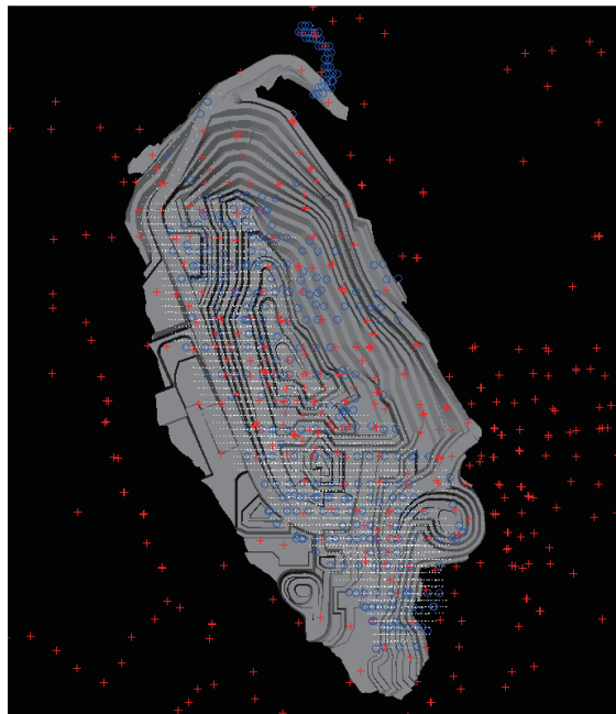
圖7：平面圖顯示GC(白點)、RC(藍圈)及DD(紅交叉)孔領位置的分佈。於二零一五年十二月的初步礦坑設計。
