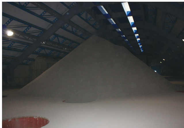
由次階段及最終階段研磨及篩選設施所生產的預選礦
