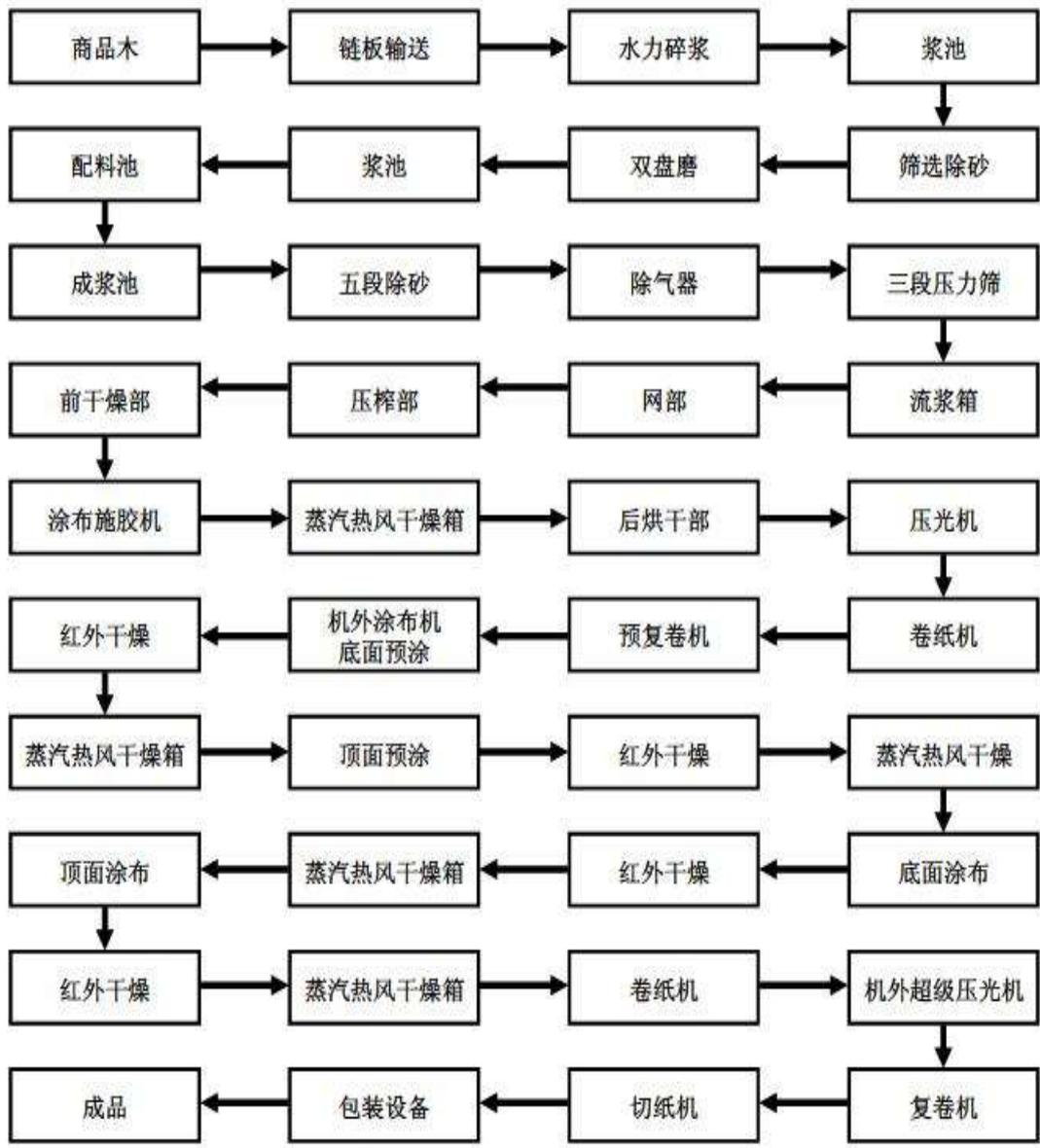
(2) 箱板纸生产工艺流程
