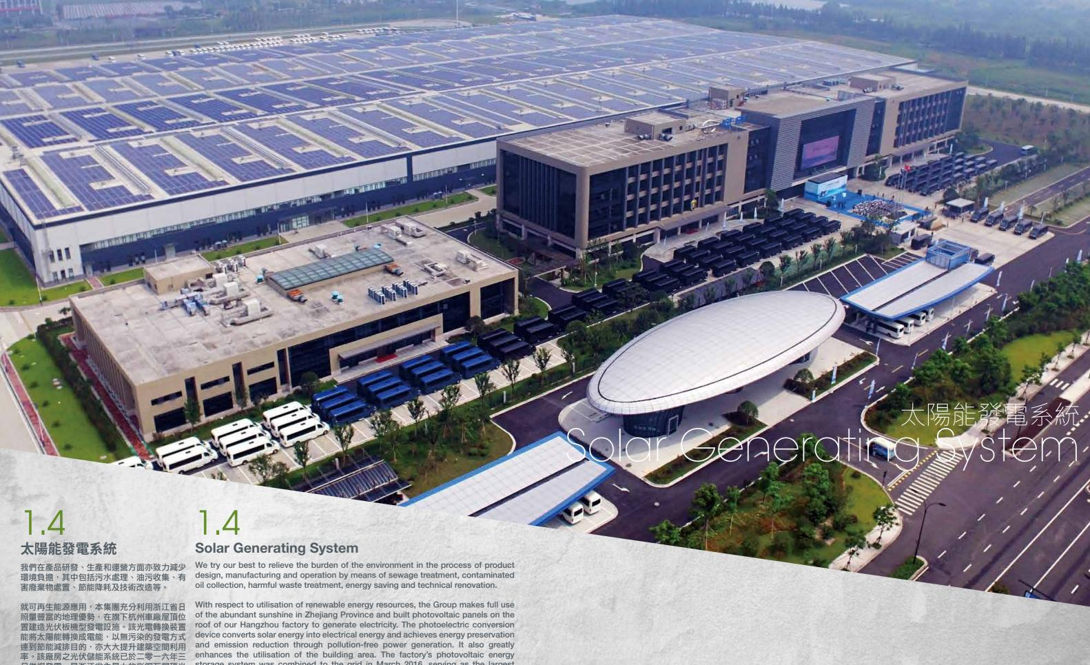
月併網發電,是浙江省內最大的彩鋼瓦屋頂光 伏發電項目。項目依托20萬平方米的廠房屋 頂,總裝機量8.68兆瓦,採用自發自用、餘 電上網的模式,預計年均發電量將超過800萬 千瓦時,短期內可以滿足企業25%的用電需 求,將有助減少對國家煤電的消耗。
