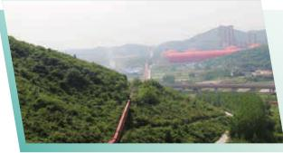
案例:建德海螺礦山管理的亮點在於其採用的豎井平峒生產工藝,即開採的礦石經過處理後通過皮帶輸送到豎井口,經高空自由墜落再輸送到石灰石堆場的做法,使原先2000米的輸送帶減少到400米,減少了巡檢工人,還縮短了礦車運距,平均每年節約的用電量折合標煤約580噸。
