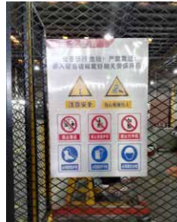
生產設備防護欄及安全標志生產設備安全聯鎖裝置
