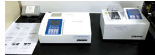
港機勢必銳的廢水處理測試設備
