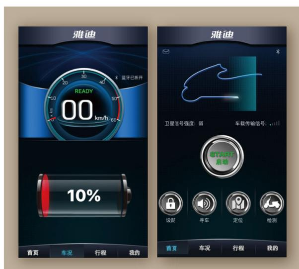
該系統通過「YADEALINK」平台將GPS位置信號及車輛防盜報警信號實時推送的用戶手機APP上。如車輛遭遇暴力拆卸時，車輛將會立即鎖死。
