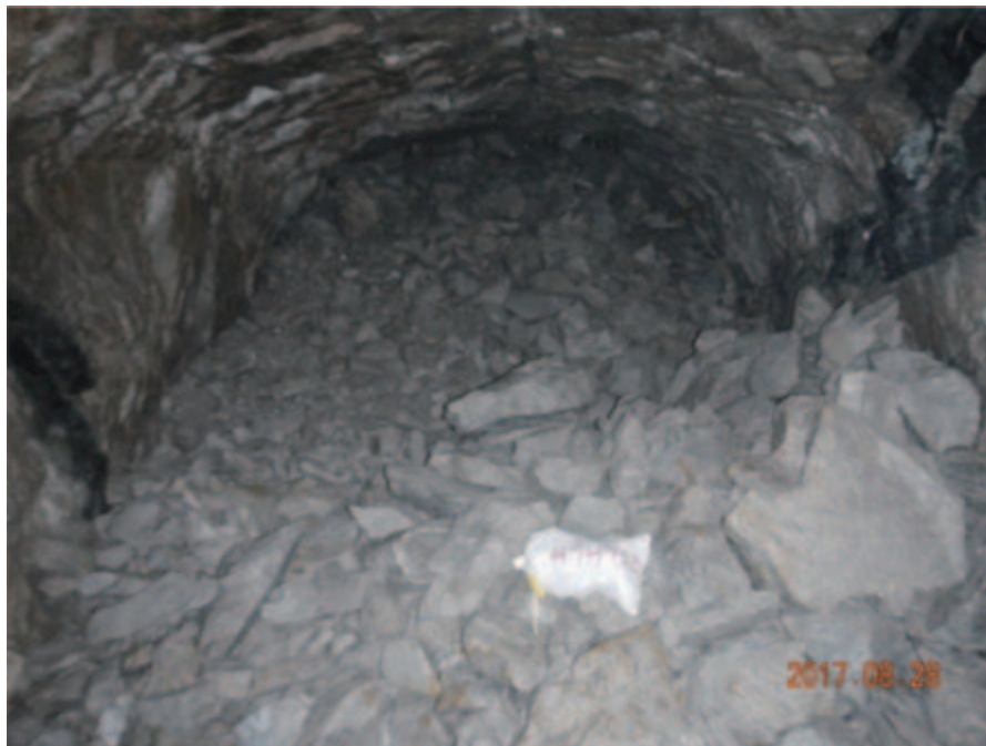
圖 12-1. 九曲礦段 175 脈—370 米中段放礦點抓取樣品
