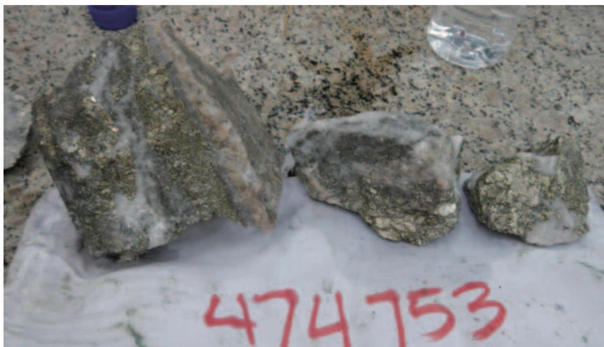
圖 12-2. 九曲礦段高品位脈抓取樣品，樣品編號 474753， 通標標準技術服務(天津)有限公司火試驗結果為 62.8 克／噸
