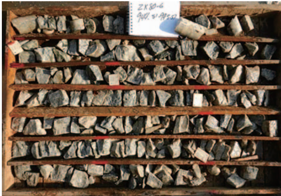
圖 12-3. 東風礦區典型的NQ鑽孔岩芯，ZK80-6
