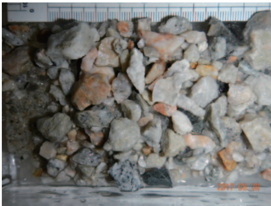
圖 12-5. 玲瓏金礦磨機給礦皮帶上收集的破碎球磨機給礦樣品，樣品編號為 474757
