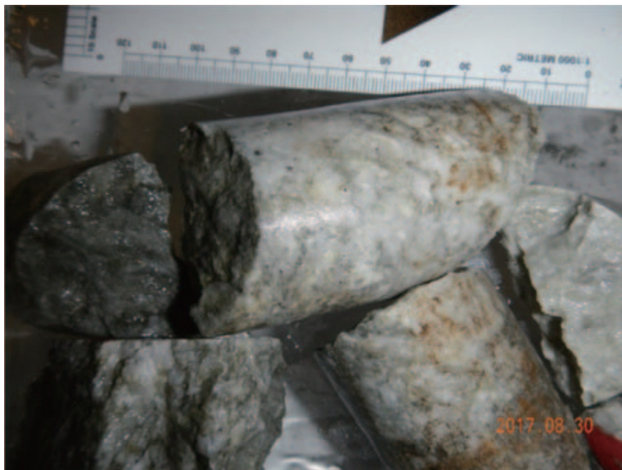
圖 12-4. 每四塊岩芯取一塊岩芯樣品時典型的樣品尺寸
