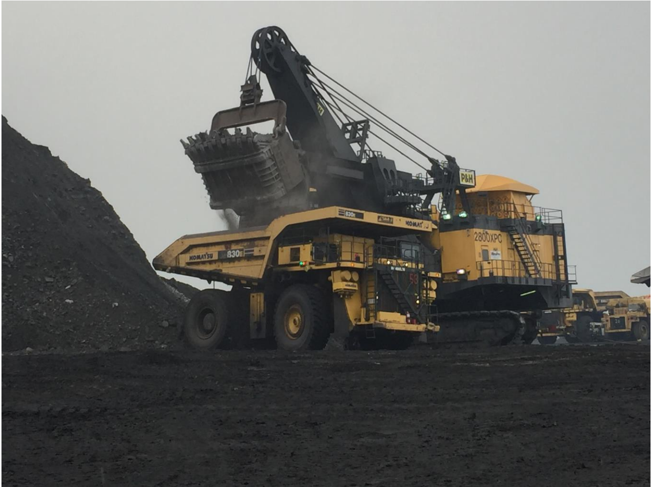
圖三：於CST煤礦，由P&H 2800 XPC鏟裝機裝載煤炭至托運卡車。
