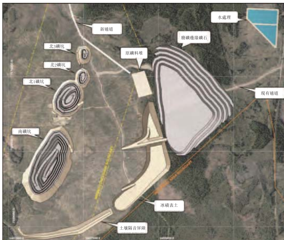
圖 10-11 Fäboliden 露天礦坑設計
