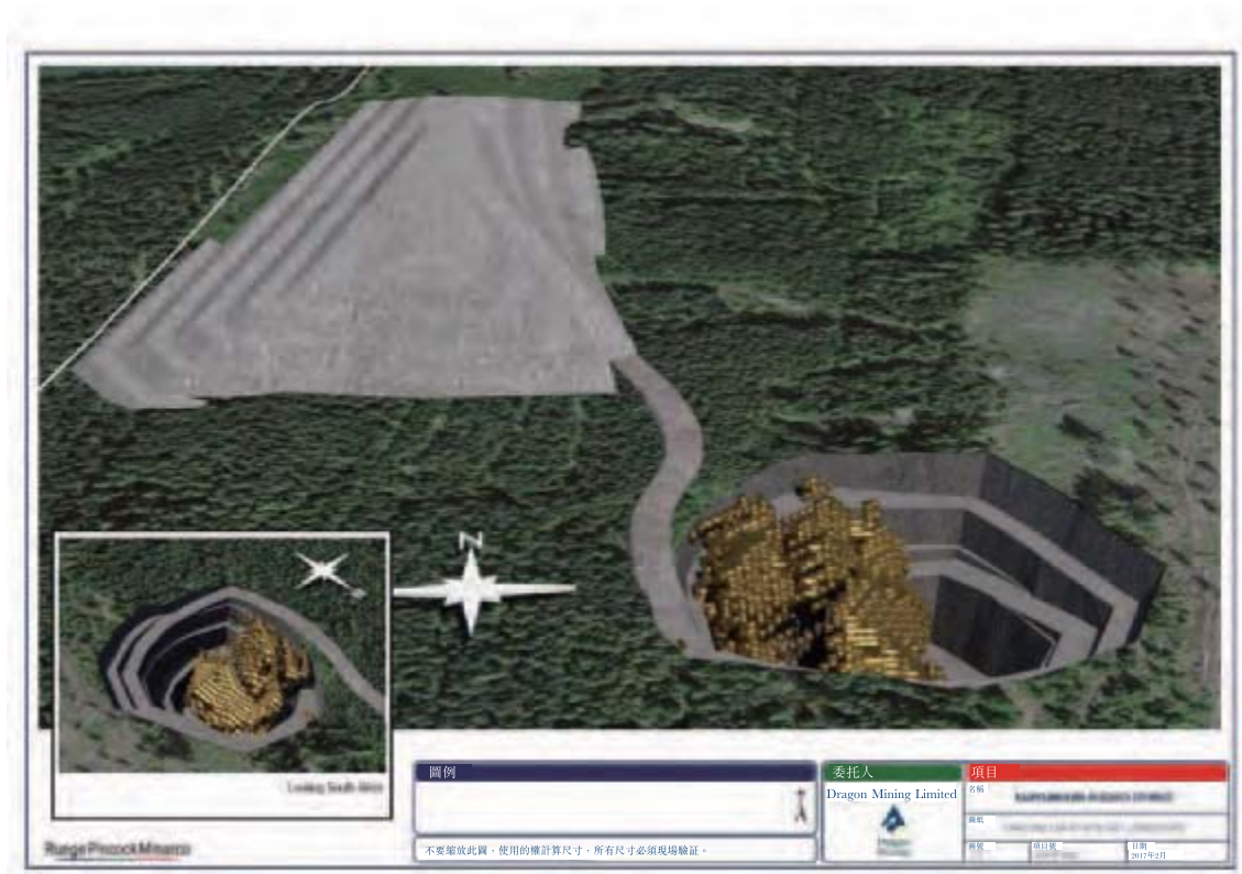
圖 10-20 Kaapelinkulma 礦坑透視圖，顯示礦石塊
