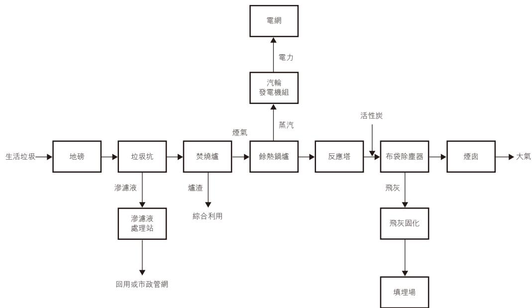
從上述工藝流程可以知悉，本集團在垃圾處理和焚燒過程當中，對環境造成影響的污染物主要為廢氣污染、廢水(垃圾坑的滲濾液和污水)、固體廢棄物(爐渣和飛灰)及設備噪音等。本集團採用了先進的污染防治技術及嚴格的污染防治措施，而內部針對各主要污染物排放的標準往往比國家標準更高，進一步鞏固了集團的環境工作。就以上主要污染源，本集團制定的相關措施詳見如下。
