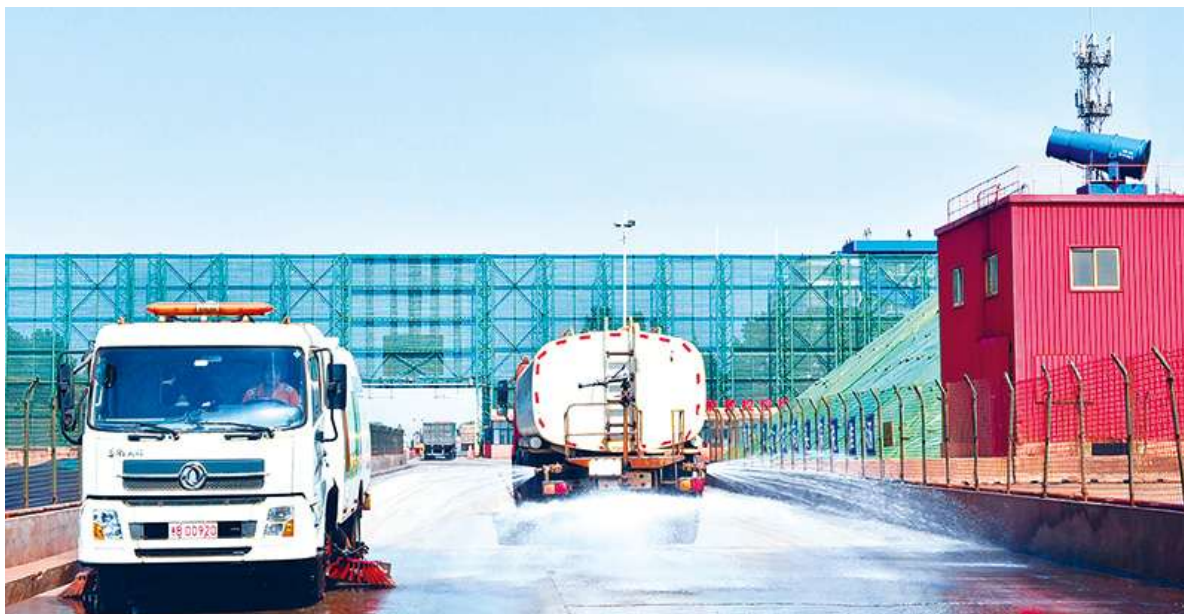
董家口港区采用雾炮、洒水车、清扫车相互配合，形成立体化环保抑尘系统
