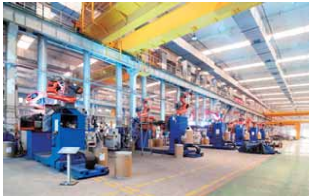
We use welding robots to replace manual work 我們使用焊接機器人替代原有的手工焊機
