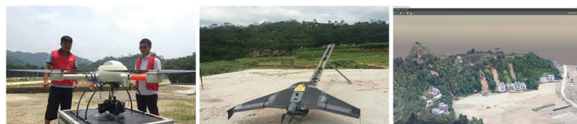
長續航多軸無人機傾斜攝影平台 航拍使用的瑞典高速固定翼無人機系統 受災區域傾斜航空攝影三維立體圖
