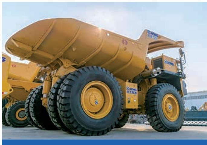
本次配套的大型礦卡貨箱承重能力150噸以上，共12台，由徐工設計，大明重工完成製作工藝和加工。從鋼板定制、下料、拼裝、焊接、機加工車銑配鑽、噴塗、包裝，所有程序控制均嚴格按照ISO和AWC標準執行。靖江大明重工項目團隊嚴格按照項目計劃執行，各部門緊密配合，相互合作，充分發揮出焊接、機加工和噴塗方面的優勢，在保證交期的前提下精益求精，受到了客戶高度好評。
