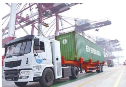
本集團3台氫能源集卡車正式投入實景測試運行，成為全國同行業首家氫能源集卡車運行應用碼頭，開啟集卡車「氫」時代。
