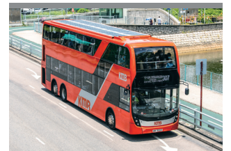
九巴在雙層巴士安裝太陽能板後，有助降低車廂溫度
