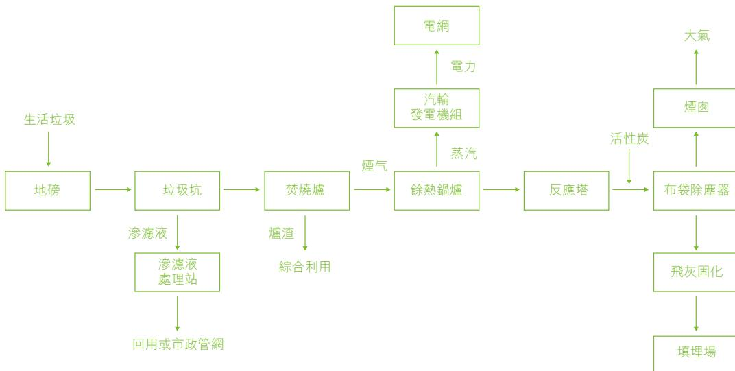
垃圾焚燒發電系統的核心設備是焚燒爐，公司主要使用自主研發的三驅動逆推式爐排爐，該種焚燒爐具有獨特的一體式三段設計，乾燥、燃燒、燃燒段均配置獨立驅動機構，可靈活根據燃燒工況調整各段的運行速度，以更好地控制火床分佈，使得灰渣熱灼減率更低。
