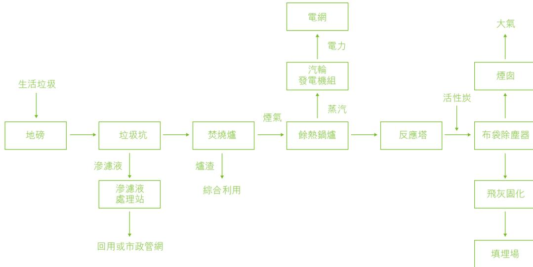
垃圾焚燒發電系統的核心設備是焚燒爐，公司主要使用自主研發的三驅動逆推式爐排爐，該種焚燒爐具有獨特的一體式三段設計，乾燥、燃燒、燃燼段均配置獨立驅動機構，可靈活根據燃燒工況調整各段的運行速度，以更好地控制火床分佈，使得灰渣熱灼減率更低。
