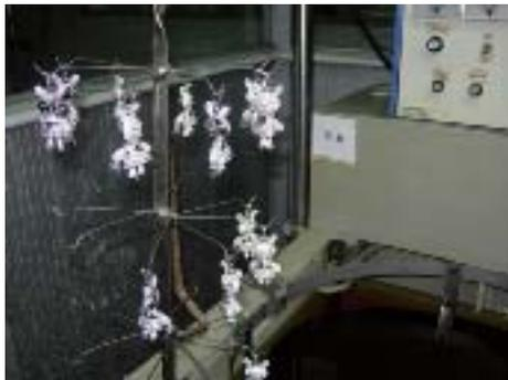
7. 滴油工序 — 我們於滴油工序中使用優質環氧樹脂漆，可生產多款色漆。我們將上油產品以特定時間烘乾，確保顏色不容易脫落。
