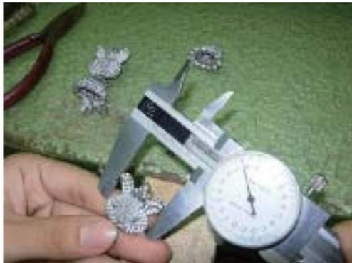
3. 倒模工序 — 我們採用離心鑄造法及脫蠟鑄造法等科技，並於倒模工序採用錫合金、鋅合金、銅、銀等金屬。為確保每次倒模均可以一次過完成，我們在壓力、熔解度、溫度等各方面進行密切監察。倒模所採用的不同金屬能減低本公司於反覆多變的中國金屬市場內所面對的風險。
