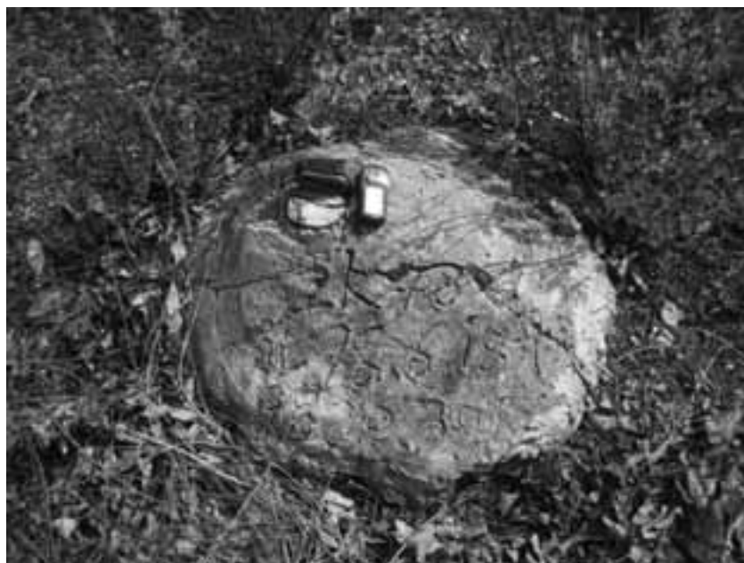
圖 6-8：密封鑽孔井口 — 紅莊礦區 ZK482
