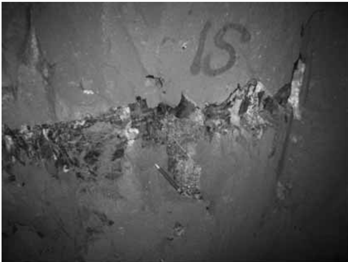
圖 7-1：坑道壁的槽探採樣－紅莊礦區
