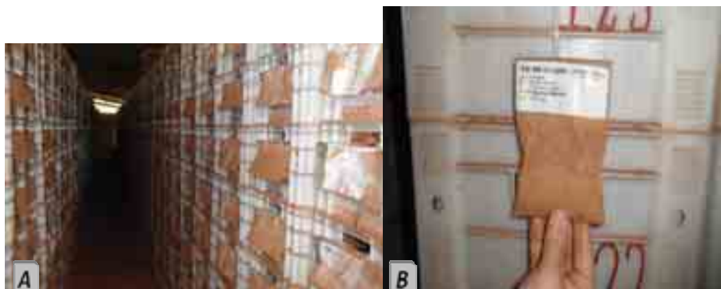
圖 7-11：A) 礦漿和拒收粗粒儲存區的全視圖。B) 裝有退回拒收礦漿的紙袋
