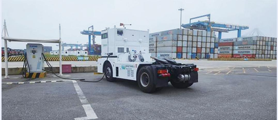
圖註：集裝箱碼頭自動駕駛清潔能源拖車
