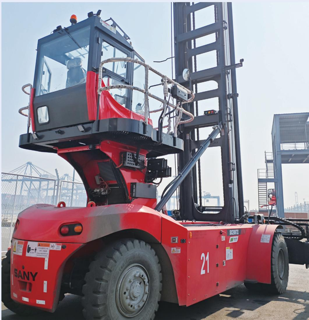
圖註：電動空箱堆高機
