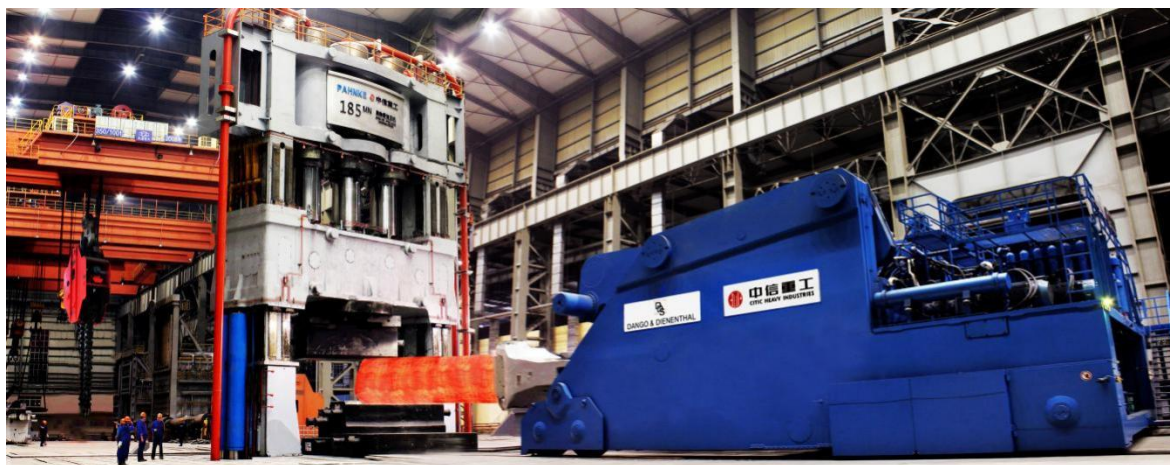
图示：中信重工构建的以 18500 吨自由锻造油压机组为核心的制造工艺体系
